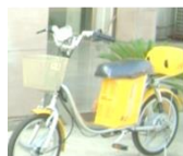
จักรยานไฟฟ้าที่ใช้ zinc-air แบตเตอรี่ สามารถขี่ได้นานต่อเนื่องมากกว่า 100 กิโลเมตร หลังจากการชาร์จแบตเตอรี่ 1
