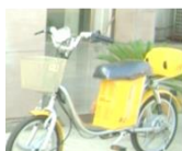
锌空电池电动自行车，一次换电可继续行驶100km以上！
