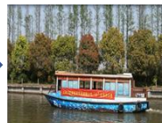
锌空电池驱动的一艘12米电动游船，运行8~10小时。
