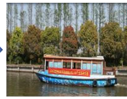
เรือโดยสารขับเคลื่อนด้วยไฟฟ้าขนาด 12 เมตร ใช้ zinc-air แบตเตอรี่ สามารถใช้งานได้นาน 8-10 ชั่วโมง
